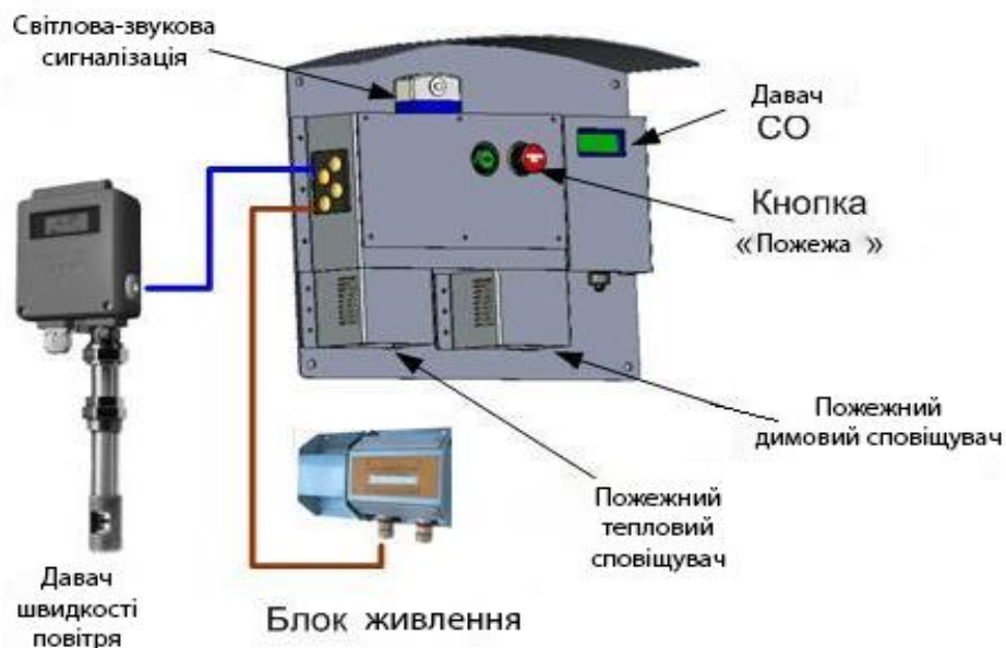
Рисунок 4.4 - Датчики контролю аерогазотермодинамічних параметрів у ШВМ
